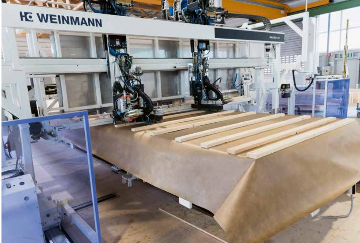
► Weinmann Wallteq M-380 beim Verlegen von Dachlatten in der Dachelementfertigung
